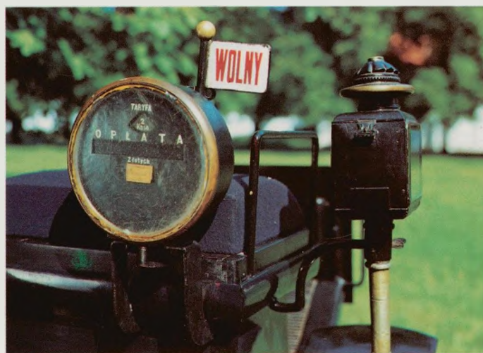
71. Licznik - taksometr z dorożki, wykonanej w wytwórni Degórskiego, Poznań, okres międzywojenny. Fot. Z. Raplewski
