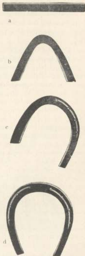
148. Przekształcenie sztaby żelaza w podkowę.
